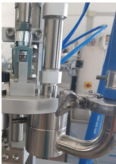
Testa anti-goccia, di serie con installazione kit olio di oliva e riempimento liquidi caldi
