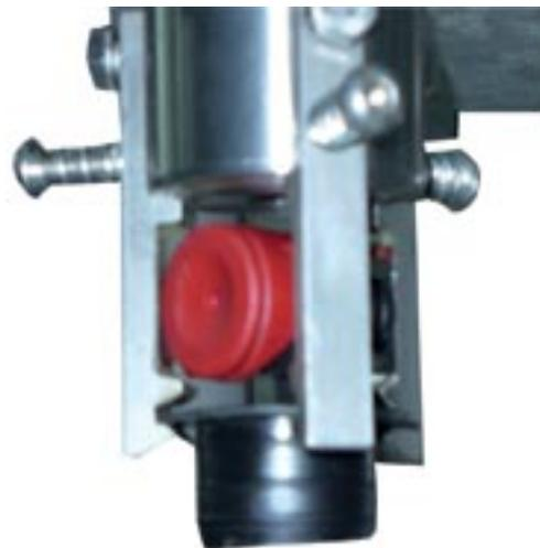
Regolare l'altezza della forcella rispetto al piano della riempitrice, in modo che, una volta riempito il sacchetto, il livello del liquido al suo interno arrivi nella parte terminale in plastica. Tale accorgimento consente di ridurre la quantità d'aria all'interno dei sacchetti, qualora non si utilizzi l'inserimento d'azoto.
