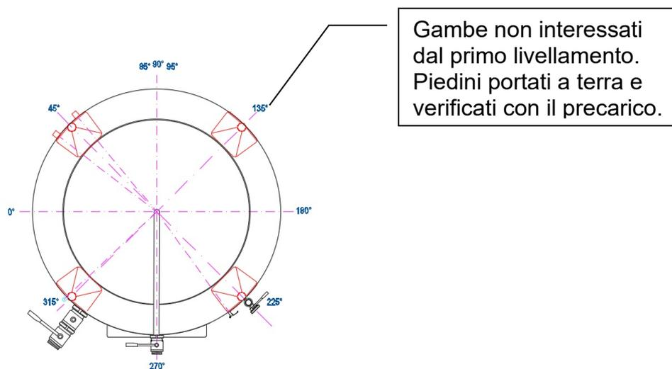
Figura 12: Fondo serbatoio con 5 gambe più supporto centrale.
