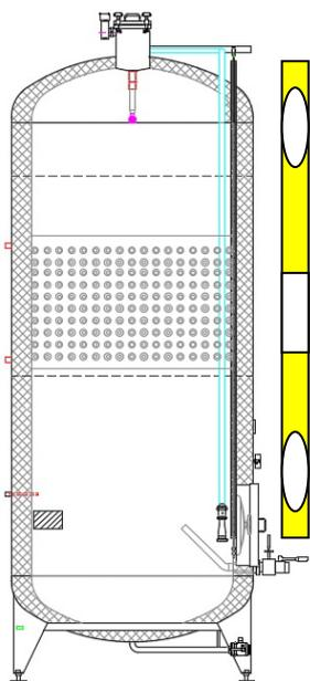
Posizionare la livella sulla parte frontale del serbatoio e tramite i piedini inferiori regolarli affinché sia perfettamente in bolla.
