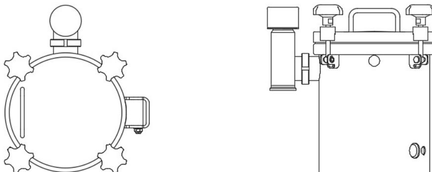
Figura 14: Chiusino AISI 304 DN 250 MM apertura a 4 galletti.
