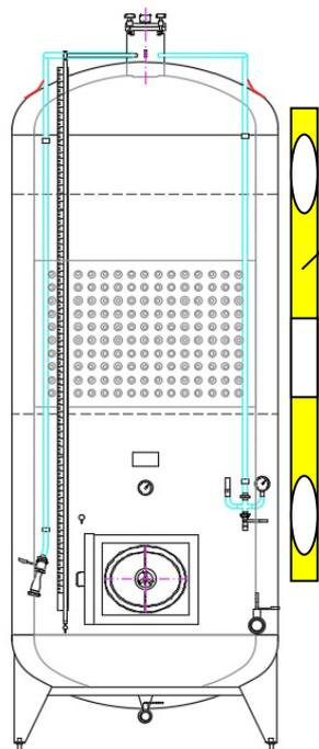
Posizionare la livella sul lato destro del serbatoio e tramite i piedini inferiori regolarli affinché sia perfettamente in bolla.
