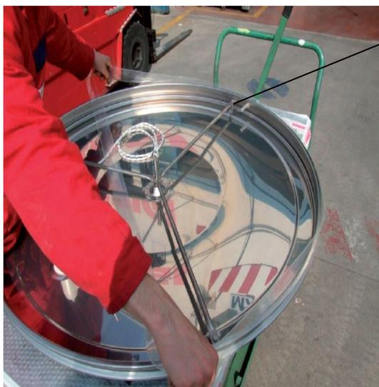
Extienda la cámara de aire e inserte el tubo de conexión en el orificio del flotador (A).
