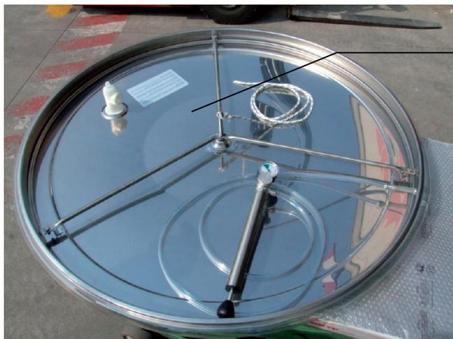
Luego monte el respiradero (A), el cable (B), la bomba con el tubo (C) y bombee la cámara de aire hasta una presión de aproximadamente 0,7 ATM.
