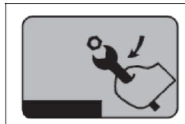
No retire ni modifique cubiertas, puertas, protectores y sensores instalados para dispositivos de seguridad activa o pasiva, sin obtener primero el permiso por escrito del Fabricante.
