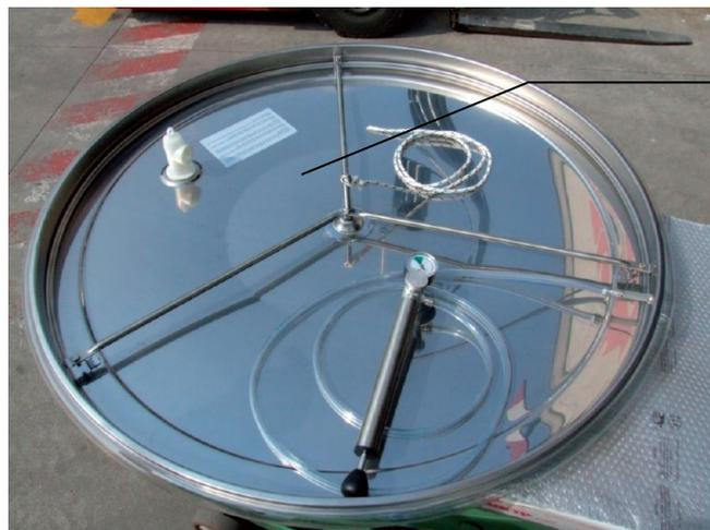
Montez ensuite l'évent (A), le cordon (B), la pompe avec le tube (C) et pompez la chambre à air jusqu'à une pression d'environ 0,7 ATM.
