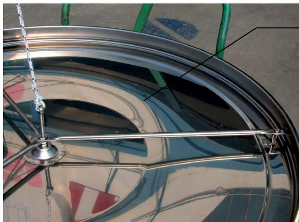
Assemblez les tirants en plaçant une vis à l'extrémité A et une vis au centre du flotteur (B).
